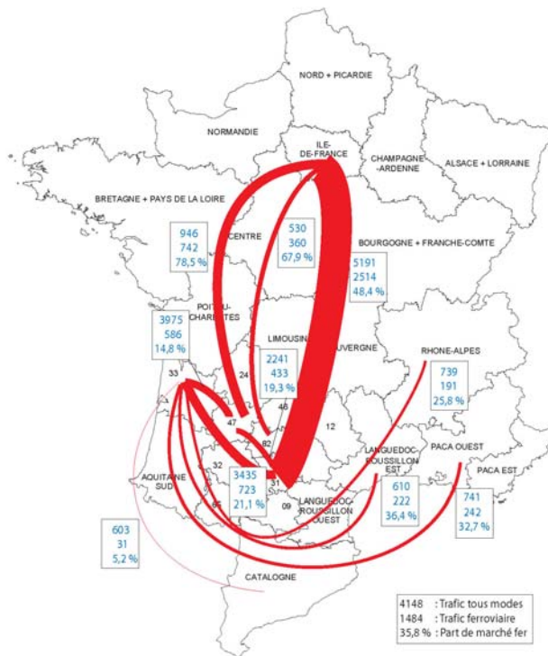
Figure 6 : Trafic sur dix relations à l'horizon 2020, dans le scénario 4, exprimé en milliers de voyageurs annuels (deux sens confondus)
