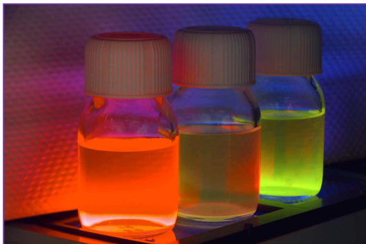
Nanocristaux de CdSe (Cadmium Sélénium) de tailles différentes sous lumière UV utilisés en imagerie fluorescente optique © Artechnique/CEA
